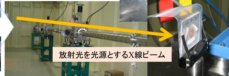
-----500 nmに絞ったX線を試料に照射して、元素の分布を把握-----
